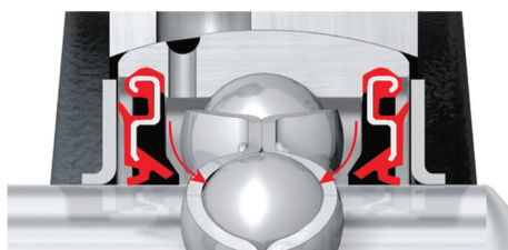
Fig. 3: Nouveau design du joint pour une meilleure lubrification
